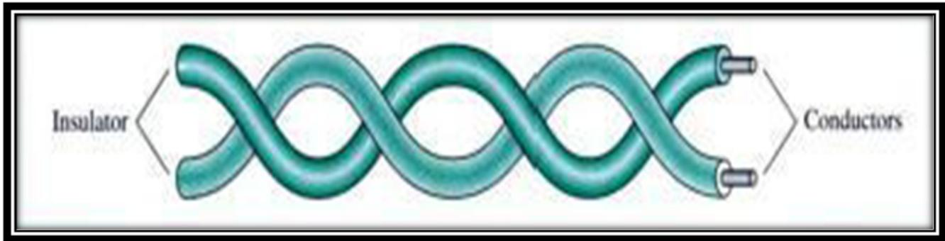
***Figure (3) Twisted-pair cable***
